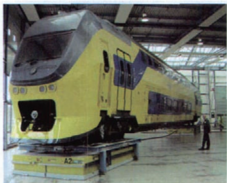
图6 DELU公司生产的气垫运输设备 Fig.6 Air-cushion transport of DELU
