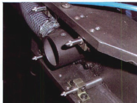
图7 位移传感器安装位置 Fig.7 Installation position of displacement sensors
